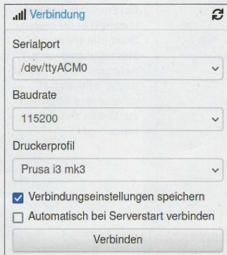
**Steuern kann Octoprint den 3D-Drucker erst, wenn die Serielle Verbindung über das USB-Kabel klappt. Für Port und Baudrate schlägt Octoprint die üblichen Werte vor und speichert sie auch für später.**
