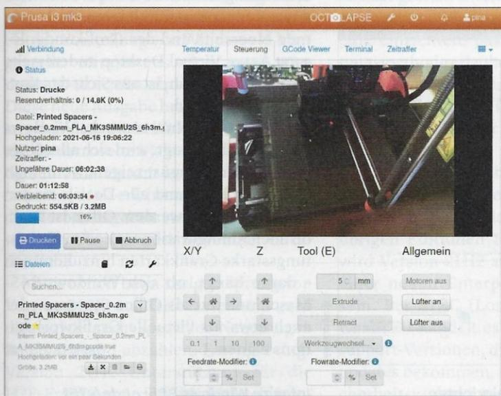
**Eine Kamera am Raspi ermöglicht es, den Drucker bei der Arbeit zu überwachen. Neben der Raspi-Kamera funktionieren auch USB-Webcams. Die gleiche Kamera schießt auch die Bilder für Zeitraffer-Videos.**
